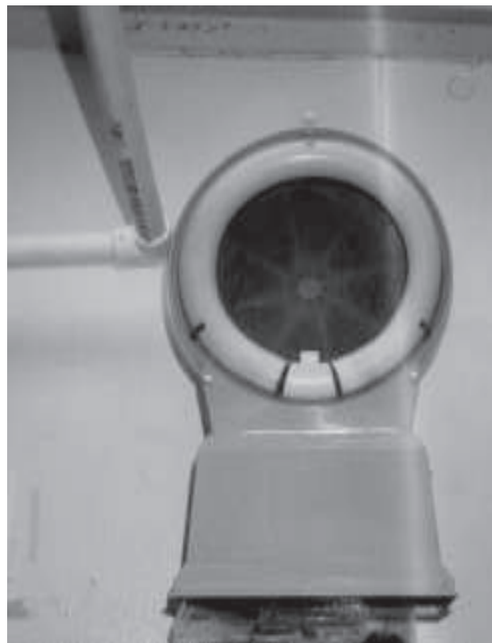
Figura 11: Armadilha luminosa para captura de insetos adultos. Usada principalmente para mosquitos, apresenta sistema de sucção (exaustor) com reservatório plástico (para contenção) que pode ser substituído.
