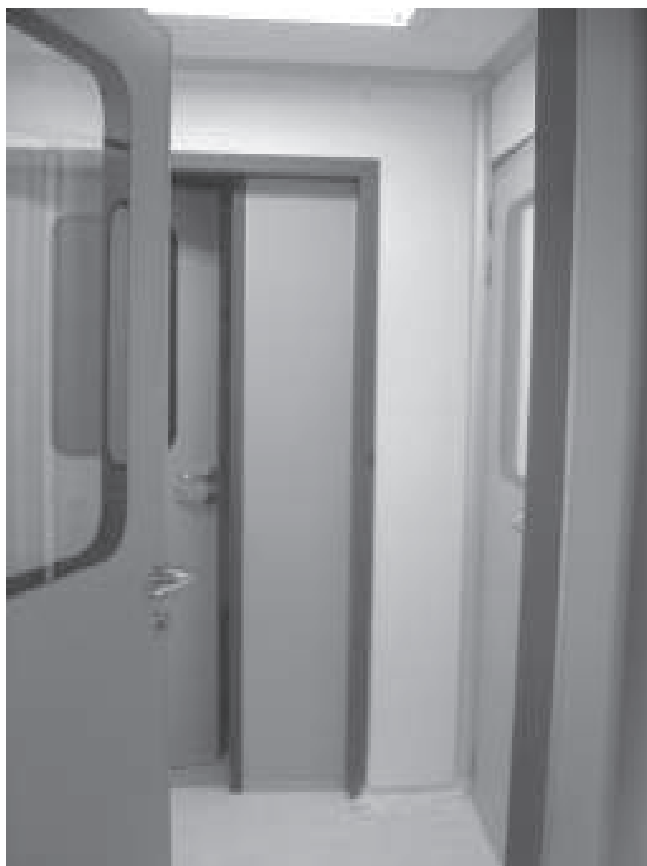
Figura 1: Antecâmara com sistema de portas duplas, apresentando visores. É recomendado, no acesso ao insetário, que o visor da porta interna seja maior que aquele da porta externa.
