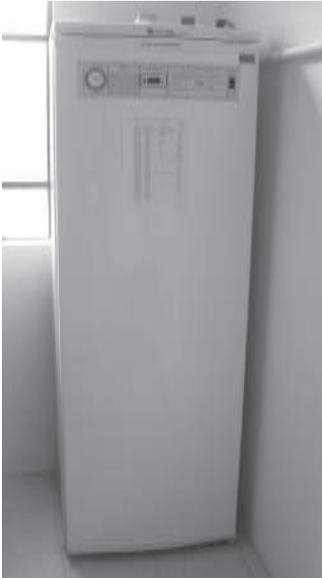
Figura 9: Estufa tipo BOD para manutenção ou experimentação de insetos.
